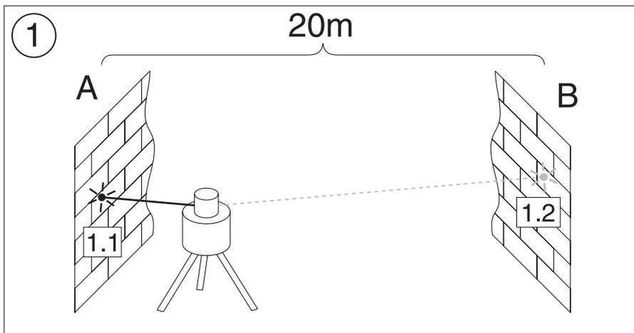
Placez maintenant l'appareil à proximité du mur B. Dirigez le faisceau laser de l'appareil nivelé dans le sens de l'axe X vers le mur B alors à proximité de sorte que la hauteur marquée auparavant (à partir de la mesure du mur A) est réalisée. Tournez l'appareil de 180°, laissez-le se niveler et marquez le centre du faisceau sur le mur A. La différence (h) des deux points marqués indique alors l'écart effectif l'appareil.
