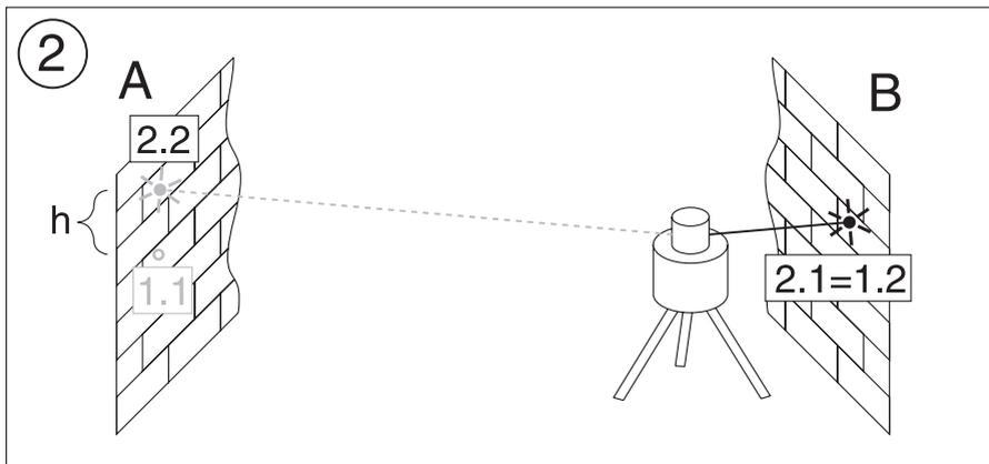
Lorsque l'appareil est dans les limites de la précision d'usine ( $\pm 1,0$  mm sur 10 m), l'écart maximal à 20m+20 m= 40 m par rapport à la position zéro s'élève à 4 mm.
