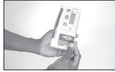
2. Faites glisser la rainure du récepteur sur la languette de la bride de fixation jusqu'à ce qu'elle s'arrête sur la butée de bord.
