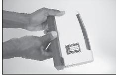
**Remarque:** Les encoches de marquage des deux côtés du récepteur/monture magnétique s'alignent sur la partie à la cote de la cellule photoélectrique et on les utilise pour marquer les mesures de position verticale. Les encoches de marquage se trouvent à 50 mm (2 inch) du haut du récepteur/monture magnétique.
