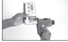
4. Pour fixer la bride de fixation à une mire, tournez le vis dans le sens rétrograde pour ouvrir la bride de fixation.
