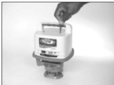
**Remarque:** Le laser possède une protection contre une inversion de polarité. Si les batteries sont placées de façon incorrecte, le laser est protégé contre tout dommage mais il ne fonctionne pas. Laissez-lui une minute pour récupérer après avoir installé correctement les batteries.
