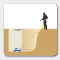
REGLAGE/CONTROLE DE LIGNE: la fonction de réglage et de contrôle de ligne du laser de canalisation vous permet d'orienter le faisceau hors de la tranchée pour une vérification ou une définition d'axe rapide.
